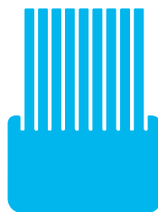
Vlákna uchycená metodou ULTRA SAFE – každé vlákno je do těla kartáče zalisováno zvlášť
