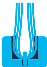
Vlákna uchycená metodou vrtání, sponkování a zalití v pryskyřici
